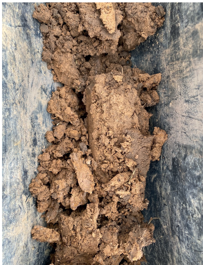
Detail jílové zeminy z vrtu V3
