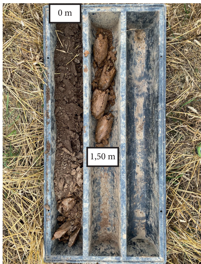
Geologický profil vrtu V2
